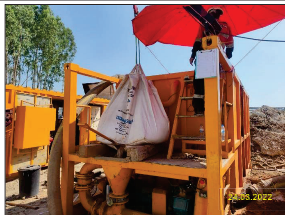
ข) การผสมโซเดียมเบนโทไนท์ให้พอดีเพื่อใช้ในการเจาะลวด
