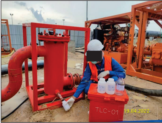
ก) เก็บตัวอย่างน้ำทิ้งจากการทดสอบท่อด้วยวิธีทางชลสถิต (Hydrostatic Test)
