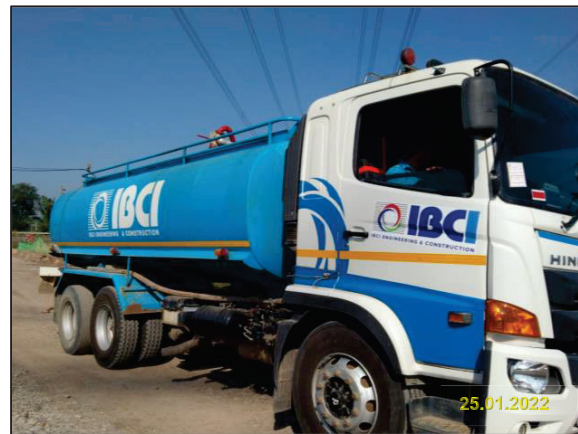
จ) รถดูด (Vacuum) สำหรับดูดโคลนโซเดียมเบนโทไนท์
