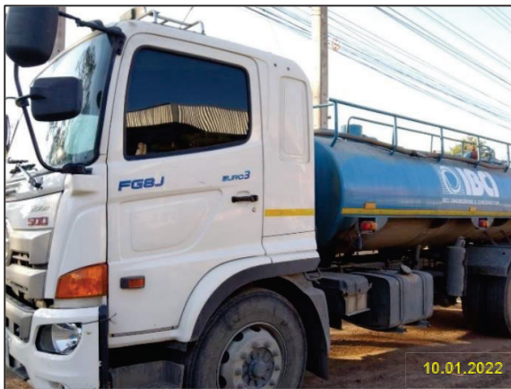
จ) รถดูด (Vacuum) สำหรับดูดโคลนโซเดียมเบนโทไนท์
