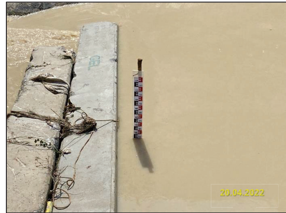
ข) ติดตั้งไม้วัดระดับน้ำ (Staff Gauge) บริเวณจุดสูบน้ำและระบายน้ำทิ้ง
